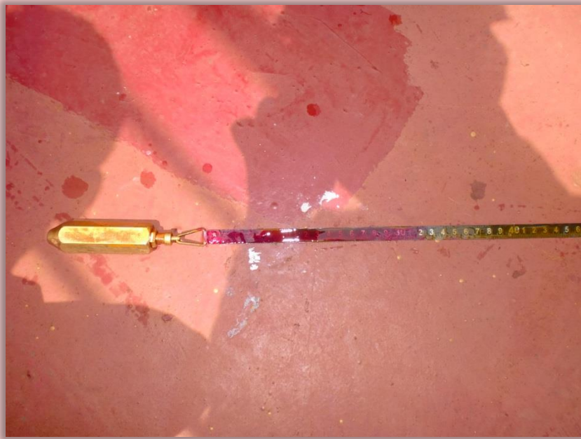
图 1: 某船舱凝析油试水膏变色情况
